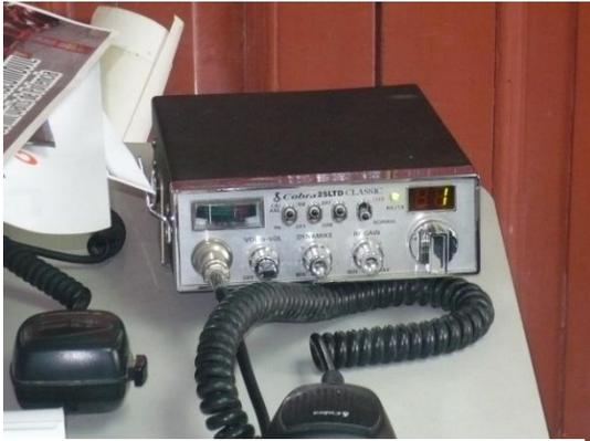
Foto No 1: Radio de 11 Mtrs. instalado en Alcaldía Municipal de Comasagua para el SAT Chilama
