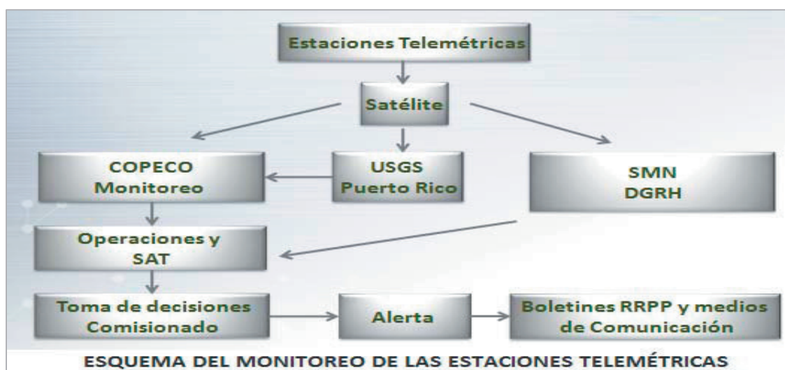
Figura 2 - 2.5 Esquema de Monitoreo de las Estaciones Telemétricas
